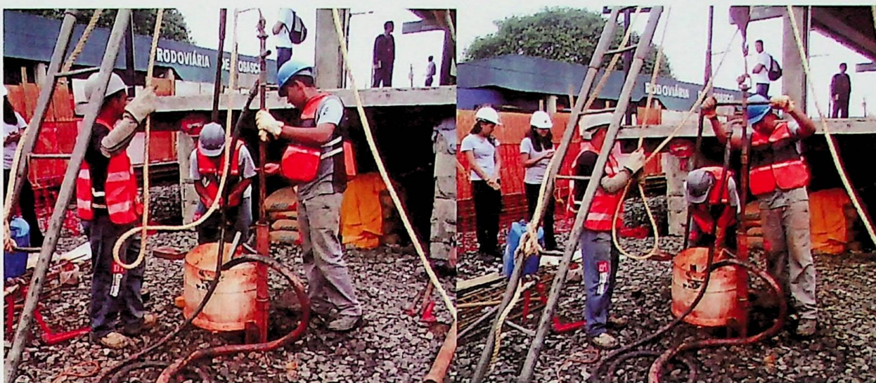
Foto 7 - Execução de Sondagem a Percussão com Ensaio SPT
